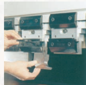
gornje sistematsko zatezanje alata s manualnim brzim stezanjem
